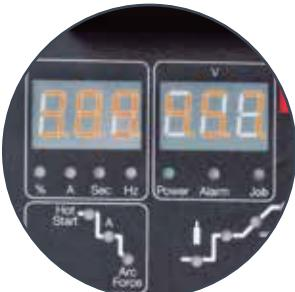
Цифровая индикация параметров сварки
