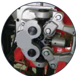
Пространственная регулировка положения горелки по 4 осям
